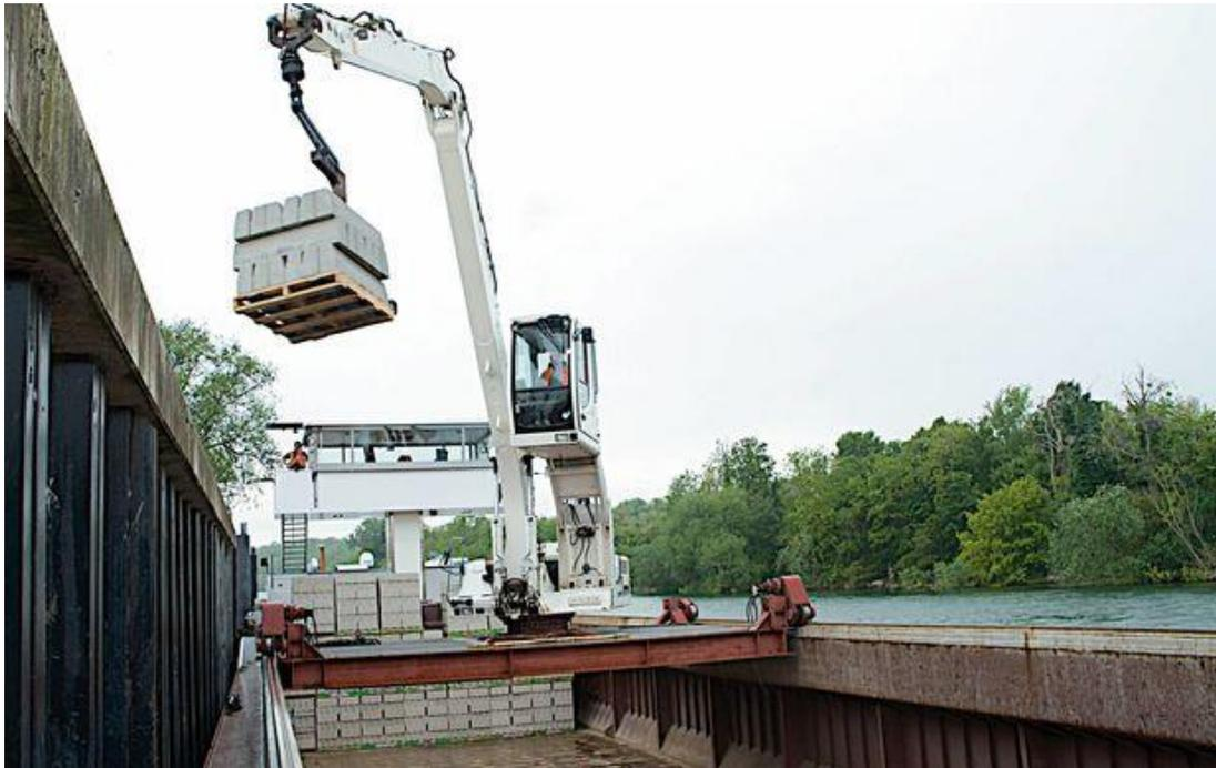
C'est aussi le cas du **Zulu**, automoteur gruté construit par Blue Line Logistics, filiale du groupe Sogestran (CFT). Le Zulu est d'un gabarit plus petit (50x6,6 mètres) mais dispose d'un pont plat de 210 m<sup>2</sup> permettant d'optimiser le chargement et la manutention de palettes et de transporter jusqu'à 320 tonnes de marchandises ou 198 palettes sur 4 mètres de haut. Il est équipé d'une grue HIAB X-Hipro rétractable (qui se replie à l'intérieur du bateau) d'une portée de 12 mètres.
